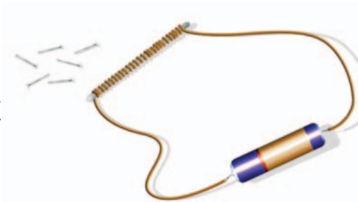
Este artefacto que acabás de construir se llama electroimán.
