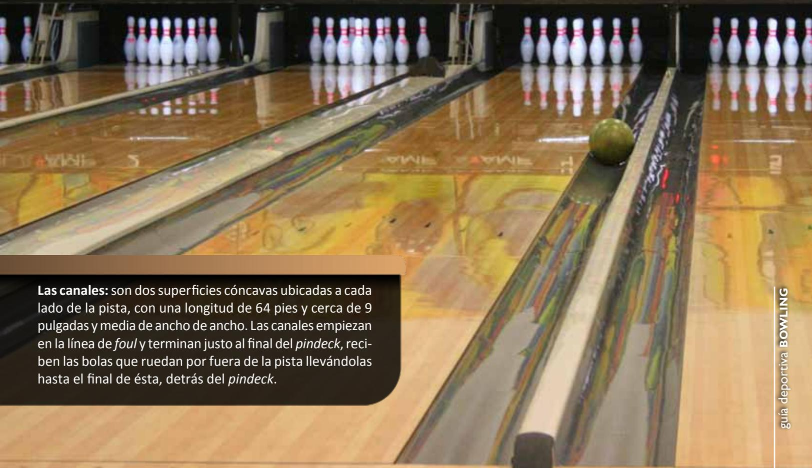
**Las canales:** son dos superficies cóncavas ubicadas a cada lado de la pista, con una longitud de 64 pies y cerca de 9 pulgadas y media de ancho. Las canales empiezan en la línea de *foul* y terminan justo al final del *pindeck*, reciben las bolas que ruedan por fuera de la pista llevándolas hasta el final de ésta, detrás del *pindeck*.
